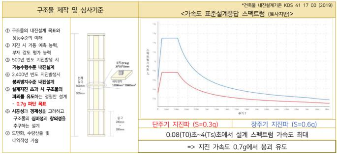
\*단주기 설계 스펙트럼 가속도 (Sds) = Sx2.5xFa(1.5)x2/3 \*장주기 설계 스펙트럼 가속도 (Sd1) = SxFv(1.5)x2/3
